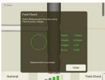
4. ウィンドウが開き、自動的に精度を測定します。ターゲットとプローブに問題がなければ「Pass」(図 31)、精度が確保できなければ「Fail」と表示されます。(図 32)
