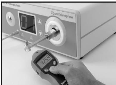
6. 速度を測定します。(適正值=425±50RPM)
