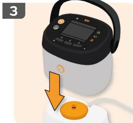
Positionieren Sie den Kanister mit dem Schlauch zur Rückseite und richten Sie die Therapieeinheit darüber aus.
