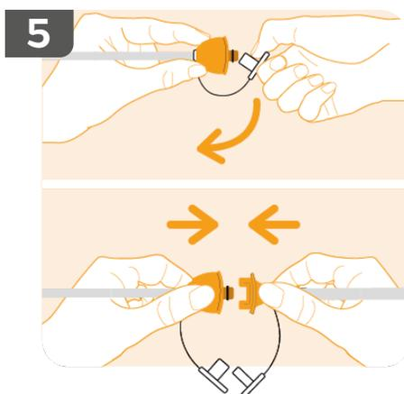
Entfernen Sie die Kappen von beiden Quick-Click-Adaptern und drücken Sie diese zusammen, bis sie einrasten.
