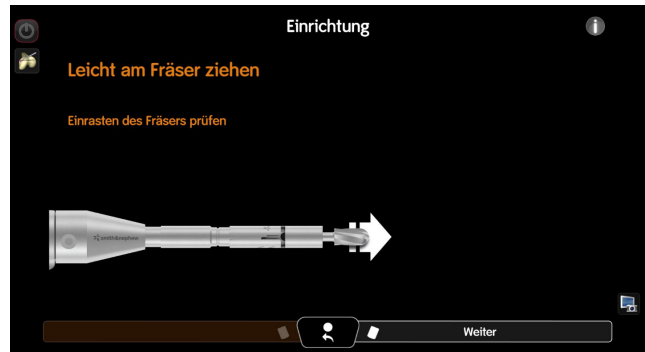
Abbildung 43. Bildschirm Einrichtung ; dargestellt ist der Fräsertest
