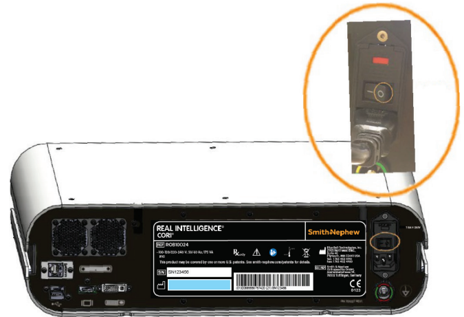
Abbildung 119. Abschalten von CORI (Schritt 3)
