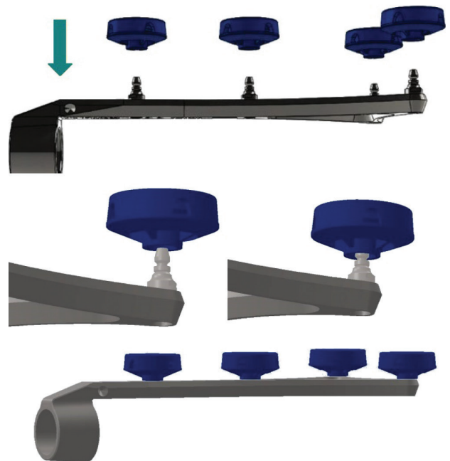
Abbildung 30. Flache Marker auf den Tracker-Stiften einrasten lassen
