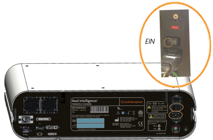
Abbildung 7. Zum Einschalten das Symbol (-) auf dem Netzschalter drücken
