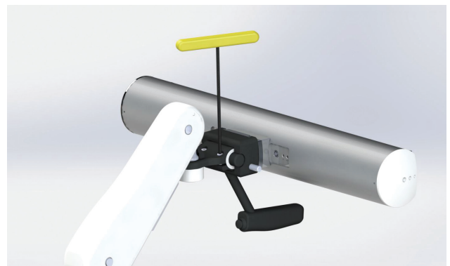
Abbildung 59. Schrauben an der Kamerabefestigung festziehen
