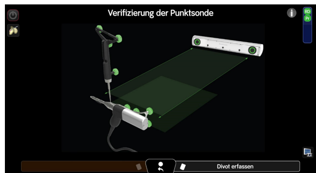
Abbildung 45. Bildschirm Einrichtung zur Überprüfung der Punktsonde
