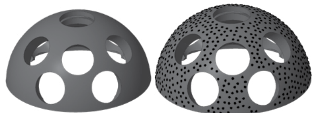
Abbildung 8: Dreidimensionales Modell vor und nach dem Aufbringen der Reibungshöcker
