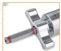
7. アコード<sup>°</sup> テンショナーを外す前に、クランプのスクリューをスクリュードライバーで締めます。
