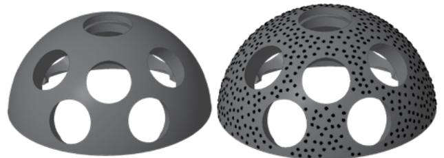
Figura 8. Modello tridimensionale prima e dopo l'applicazione dei rilievi di attrito
