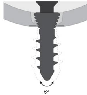
Figura 6. Vite di bloccaggio ad angolo variabile
