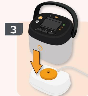
3 Coloque el depósito de modo que el tubo esté dirigido hacia la parte posterior de la bomba y después, alinee la bomba sobre el depósito
